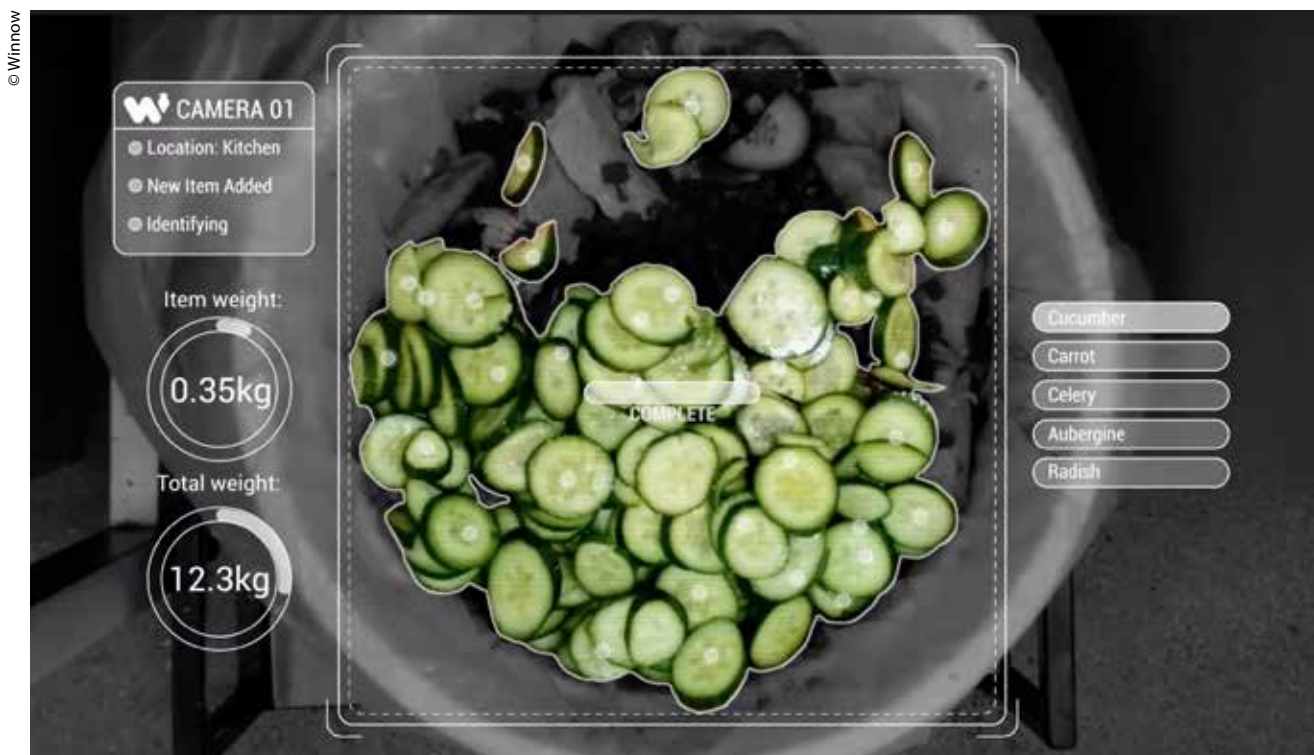
▼ Winnow, un programa británico de IA, analiza los restos alimenticios a partir de una cámara instalada sobre una papelera.
